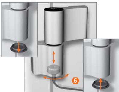
Untere Kappe entfernen. Höhenverstellung + 3/- 2 mm. Kappe aufsetzen.
