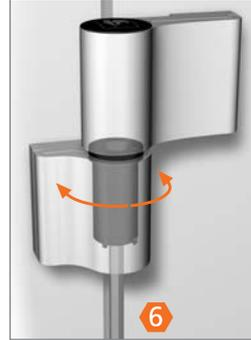
Lagerbuchse um  $\pm 90^\circ$  drehen bis sie spürbar einrastet (Dichtungsdruck  $\pm 0,5$  mm).
