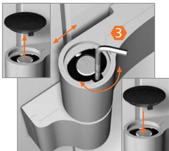
Kappe entfernen. Durch Drehen der Spindel am oberen Bandteil Horizontalverstellung vornehmen ( $\pm 2,5$  mm). Kappe aufstecken.
